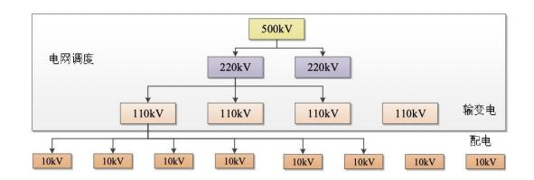
根据上图所示的结构, 高电压等级变电站停电会导致其下级系统失去电源, 电压等级越高的站出现故障影响面就越大, 而配电系统线路停电不一定影响到上 级变电站向其它线路输送电能的运行(小水电、新能源发电设备等反向对电网供 电时, 其能量低且电网也有防冲击的保护措施, 一般情况下亦不会影响整体的送 电运行)。
