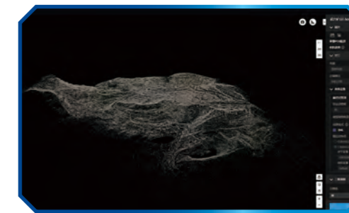
測繪級無人機礦山繪製的 3D 模型
