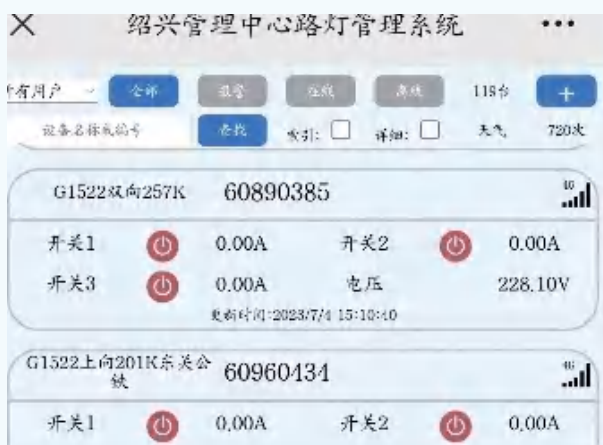
紹興管理中心創新採用4G遠程路燈控制系統實現8%的電能節約
