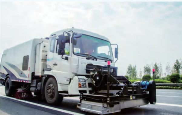
「高速公路拋灑物專項整治行動」中吸鐵車（紹興管理中心自主研發）實施作業，有效防止因鐵釘等尖銳物剝胎情況
