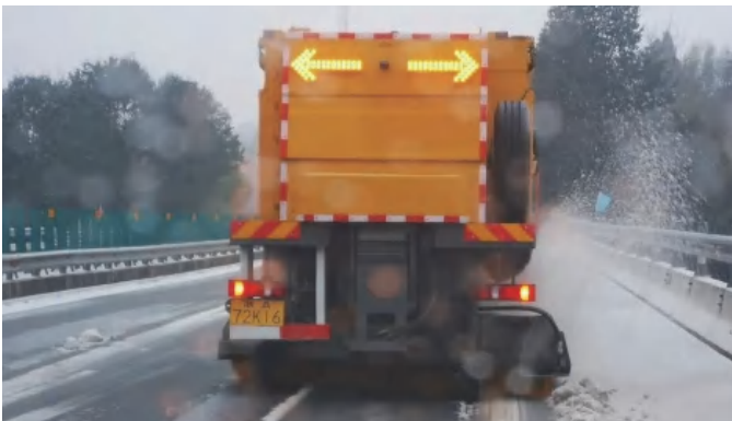
吹雪車在杭徽高速昱嶺關路段進行除雪作業
