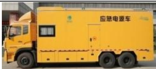
300-1000kW 低压应急电源车
