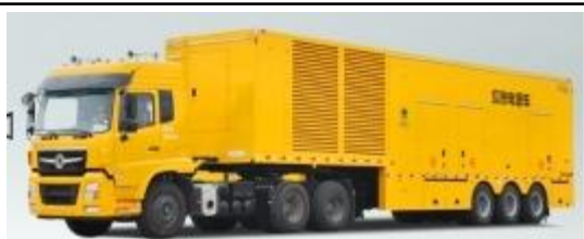
1600kW/10kV 中压电源车
