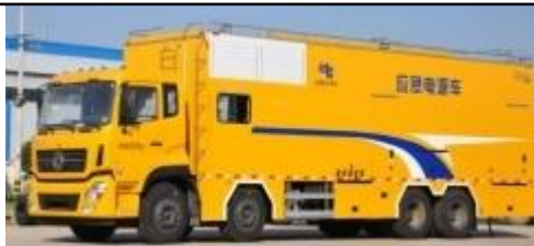
1000kW 中压应急电源车
