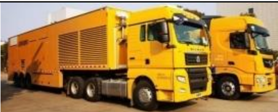
2000kW/10kV 中压电源车
