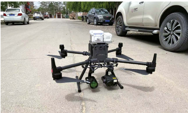
無人機天然氣洩漏巡檢系統
