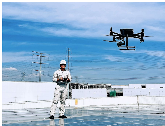
發掘低空經濟，以行業級 M300 PTK 無人機平臺對光伏電站進行數字化建模，提高自主巡檢效率
