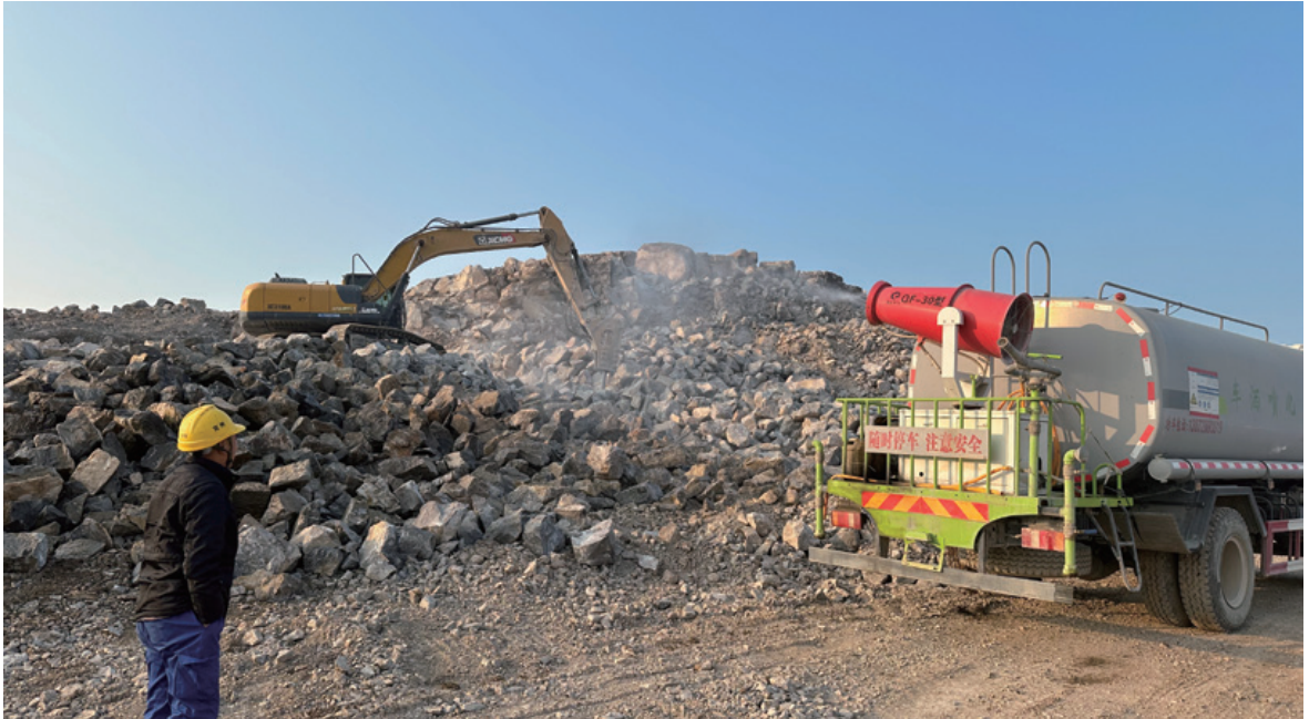
礦山開採挖裝和破碎機械採用霧炮降塵措施，一機一炮
