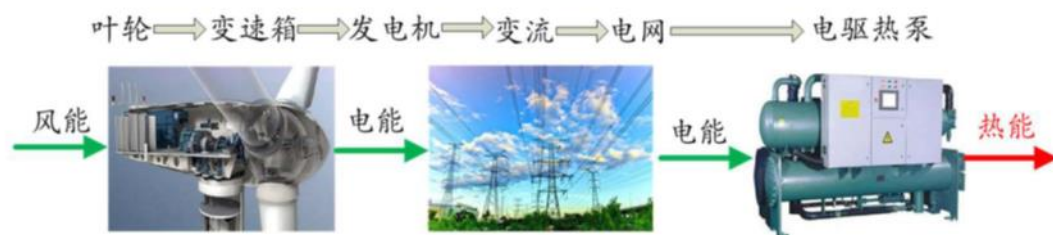
网电热泵能量转换过程
