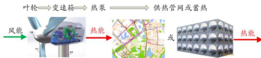
风热机组能量转换过程
