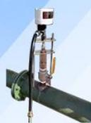
○ 电阻探针腐蚀监测仪
