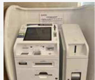
图：大堂式智能柜台+票据副柜
