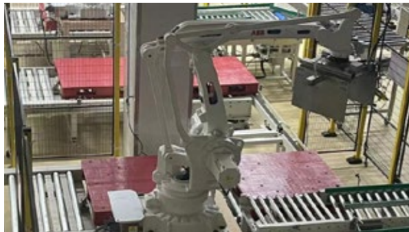
产品冷冻后由智能机械人进行包装
