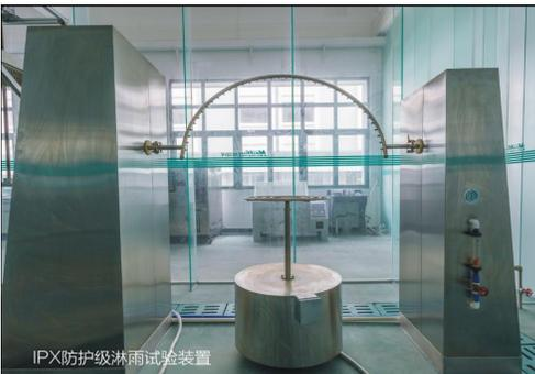
IPX防护级淋雨试验装置
