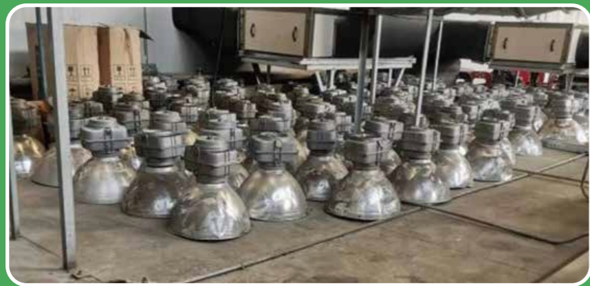
公司车间原本400w金属卤化灯, 更换成更加节能的LED照明灯, 每年可节省电量77,526度电。
