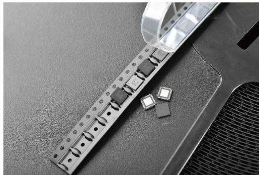
包含我們的MEMS及傳感器封裝產品的寬度為16毫米的載帶，僅供說明用途
