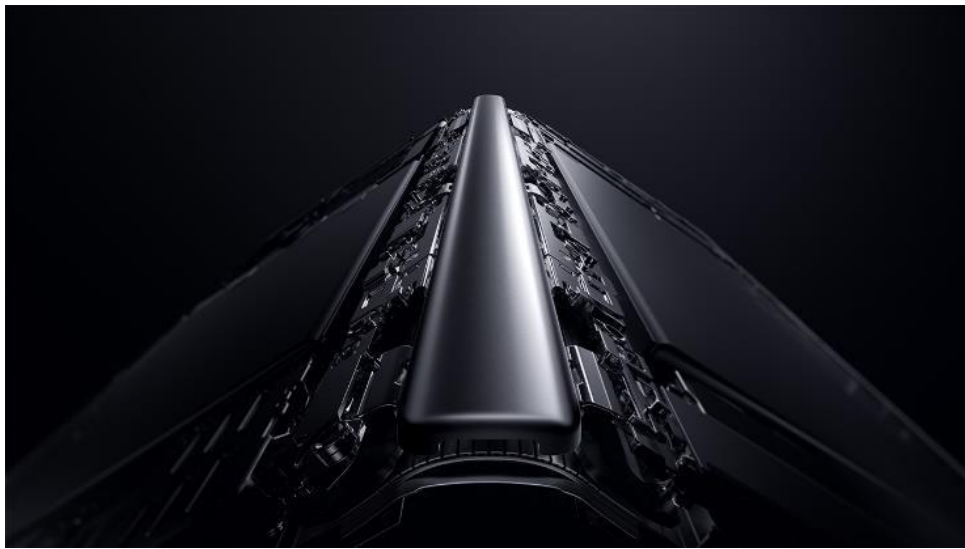
图：荣耀 Magic V2 手机钛合金铰链结构
