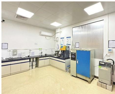
用於對水泥進行物理性能測試和性能指標評估，包括檢測標準稠度用水量、安定性、初凝及終凝時間、樣品強度測試等，並配合其他部門進行相關實驗。
