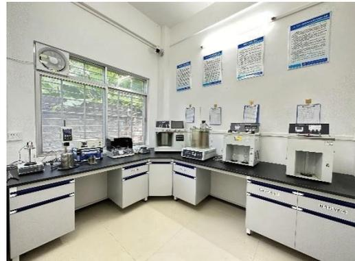
用於對各類瀝青進行理化性能測試和性能指標評估，包括但不限於：瀝青針入度、軟化點、延度、密度與相對密度、蠟含量、閃點燃點、動力粘度、標準粘度、運動粘度、乳化瀝青殘留物、乳化瀝青微粒離子電荷、乳化瀝青儲存穩定性及乳化瀝青破乳速度測試等。
