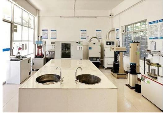
用於對瀝青混合料進行理化性能測試、性能指標評估及配合比設計。主要測試包括壓實瀝青混合料密度、理論最大相對密度、穩定度及流值、動穩定度、滲水系數、飽水率、瀝青混合料礦料級配檢驗及強度測試等。
