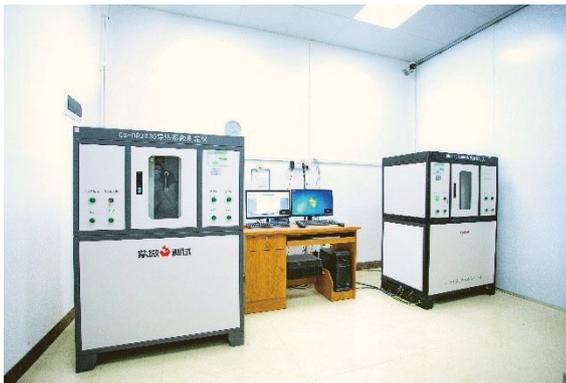
用於對保溫材料進行檢測，包括檢測建築保溫砂漿、絕熱材料導熱系數之保溫砂漿、絕熱材料導熱系數之絕熱用擠塑聚苯乙烯泡沫塑料、絕熱材料導熱系數之蒸壓加氣混凝土砌塊及外觀尺寸等。
