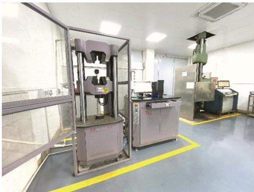
用於對金屬材料力學性能進行檢測，包括檢測材料外觀尺寸及重量偏差、進行拉伸試驗測量材料的強度，並評估材料的屈服強度及彎曲性能等。
