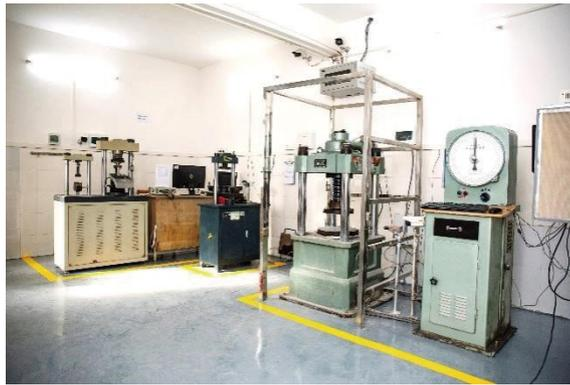
用於對非金屬材料力學性能進行檢測，包括檢測混凝土抗壓抗折強度、砂漿抗壓強度、牆體材料抗壓抗折強度及路面磚和路緣石抗壓抗折等。
