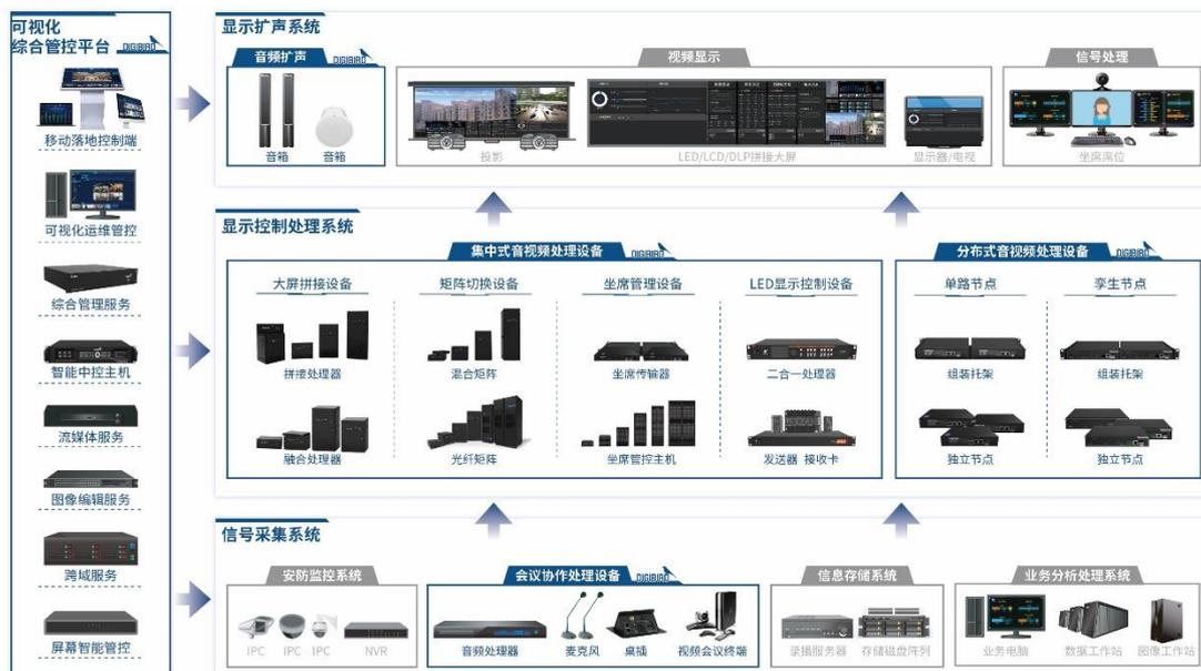
集中式音视频处理设备包括：大屏拼接设备、矩阵切换设备、坐席管理设备、会议协作处理设备、LED 显示控制设备。集中式音视频处理设备以无级缩放算法、浅压缩算法为基础，采用模块化插卡设计并结合基于 B/S 架构技术的各项嵌入式软件，最终实现视频、音频、IP 流等信号的混合接入、无缝切换、多屏拼接、KVM 切换控制等多种视频处理功能。公司集中式音视频处理设备主要进行音视频信号的传输、处理和显示控制，具有更高兼容性、稳定性、操控便捷性等特点，可实现整屏超高分辨率和高画质的显示效果，用户可以将需要显示的图文信息、影像信息、大数据态势等图像同时显示在大屏幕上，提高坐席操作员工作效率、加强各职能人员之间的沟通协作，适用于各大指挥中心及会议室等场景。
