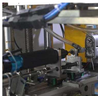
自动螺丝机（精确控制扭力）
