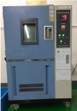
耐候测试示例：高低温测试仪
