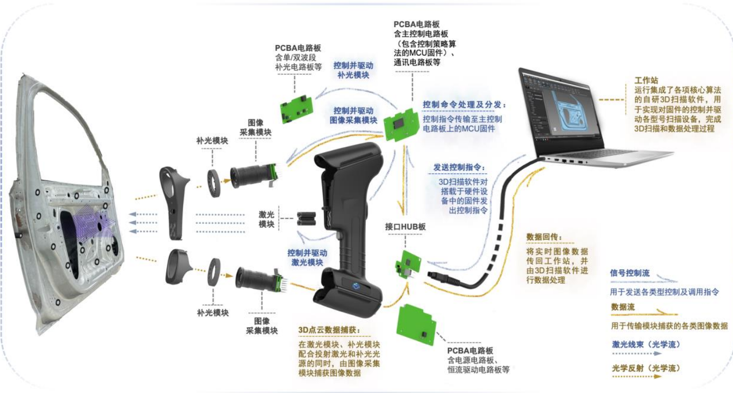
图：公司主要产品手持式 3D 视觉数字化产品的软件算法、固件及硬件调用示意图
