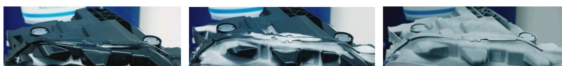
图：被测工件喷粉预处理（图左：未喷粉，图中：喷粉中，图右：喷粉后）
