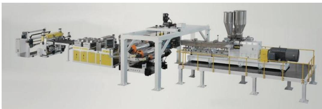
片板膜直接挤出成型装备示意图
