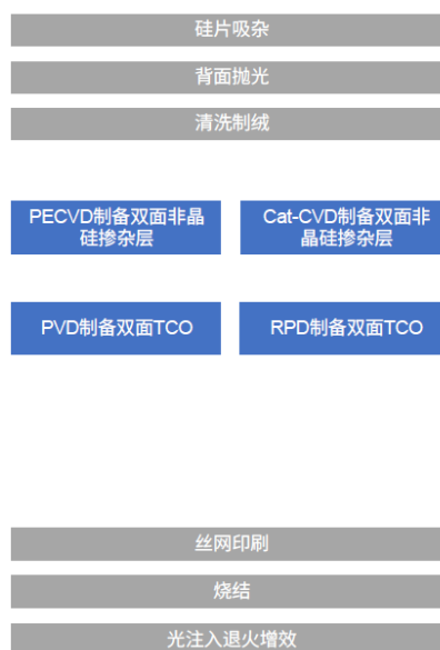
图：HJT 电池镀膜环节及所用设备
