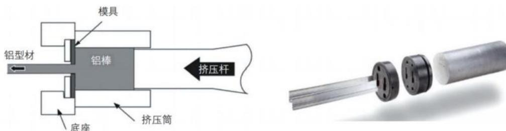
图 1-铝棒挤压成型示意图
