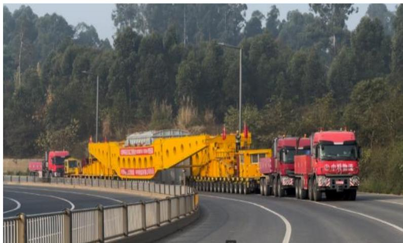
5 月，中特物流成立项目部，积极开展桥梁检算、前期方案优化、超限通行协调、道路整改方案等工作，11 月完成线路桥梁加固、道路整改、高空障碍整治、运输方案整体评审等前期工作。为保障万无一失，正式运输前，调集 47 轴线平板车、桥式车组和 3 台重型牵引车全程模拟筹划演练。
