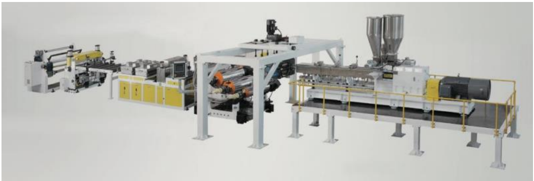
片板膜直接挤出成型装备示意图
