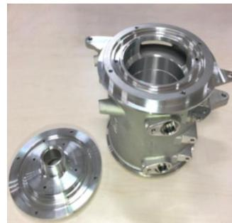
氢燃料电池汽车空压机电机壳
