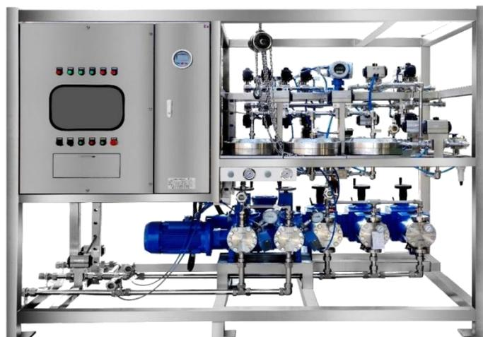
图 5-4 液相色谱系统控制单元
