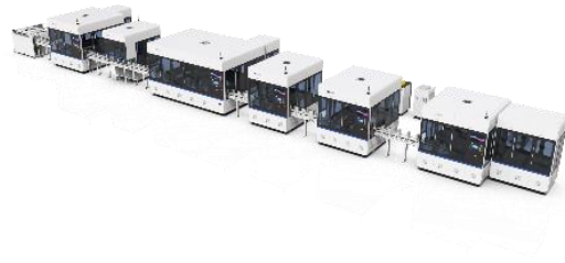
图 2：电池盖板结构件装配线
