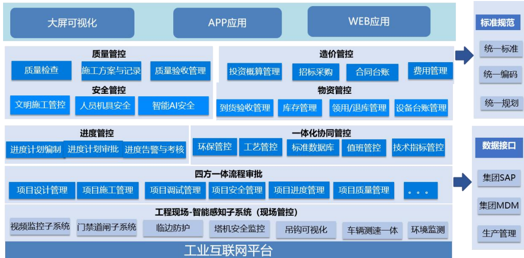
图 27：工程项目管控系统
