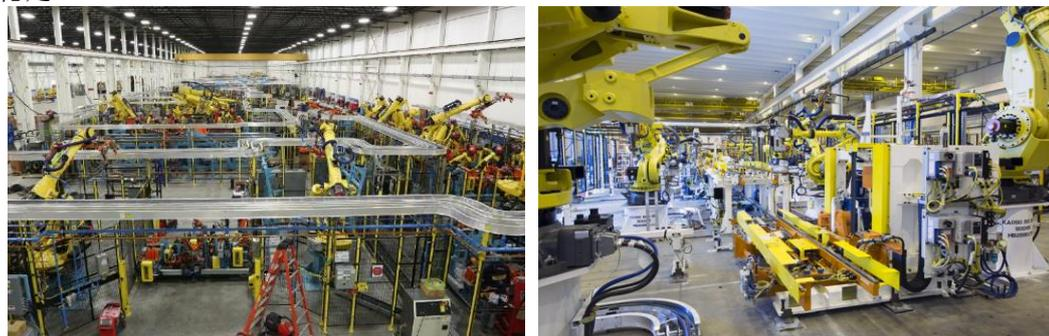
图 2. 结构件焊装自动化生产线
