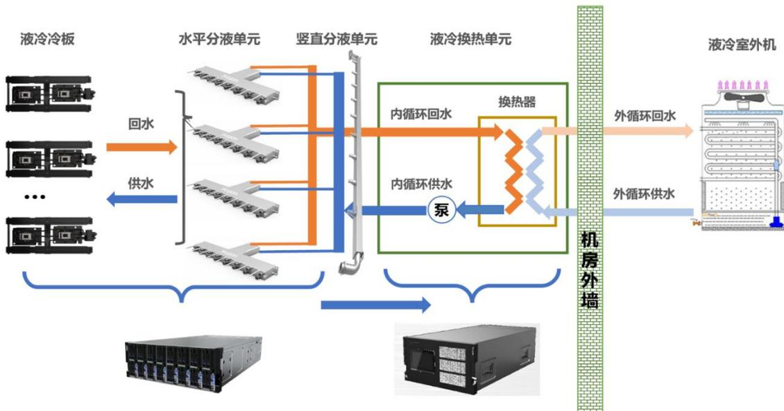
冷板液冷数据中心基础设施产品主要包含液冷服务器冷板套件、液冷机柜、封闭通道、垂直分液单元、液冷换热单元、室外冷却设备及预制化管路等产品。
