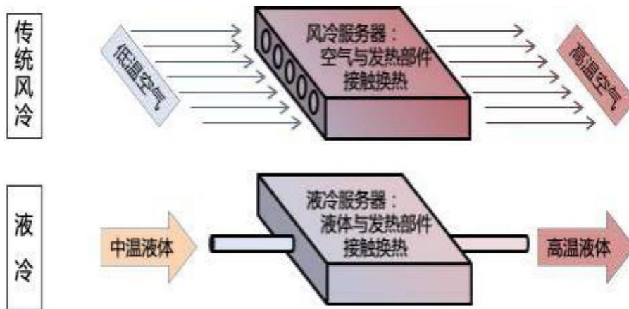
根据液冷冷却介质与服务器接触方式的不同，可分为间接冷却和直接冷却两种方式。间接冷却一般为冷板式液冷，根据冷却介质是否发生相变又可分为单相冷板式和两相冷板式。直接冷却一般为浸没式，根据冷却介质是否发生相变又可分为单相浸没式和相变浸没式。
