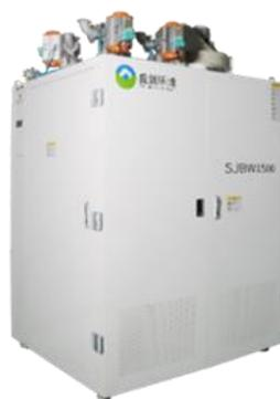
Local Scrubber 是半导体工艺设备 PFCS 污染物处理装置，用于对制程过程中产生的含氟、氯、硅等元素为代表的成分复杂的有毒有害废气进行源头处理，该设备一端与半导体工厂工艺设备相连，通过真空泵抽取工艺设备内产生的废气并进行分解；另一端与中央治理系统相连，将分解后的尾排气体排至中央处理装置并进行后续处理。L/S 属于半导体工艺制程设备的一部分，其运行稳定性及气体处理效率要求高。
