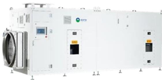
Local VOC 是一种半导体洁净室 EHS 处理装置，用于处理洁净室内弥散的 VOCs 气体。半导体行业生产车间某些区域循环风中含有一定量的挥发性 VOCs 气体，影响职业健康和产品良率。含有 VOCs 的气体通过沸石，VOCs 被吸附，洁净气体排至车间，小风量的高温气体从沸石上脱附出高浓度的 VOCs，排至 VOCs 中央处理装置，集中处理达标排放。
