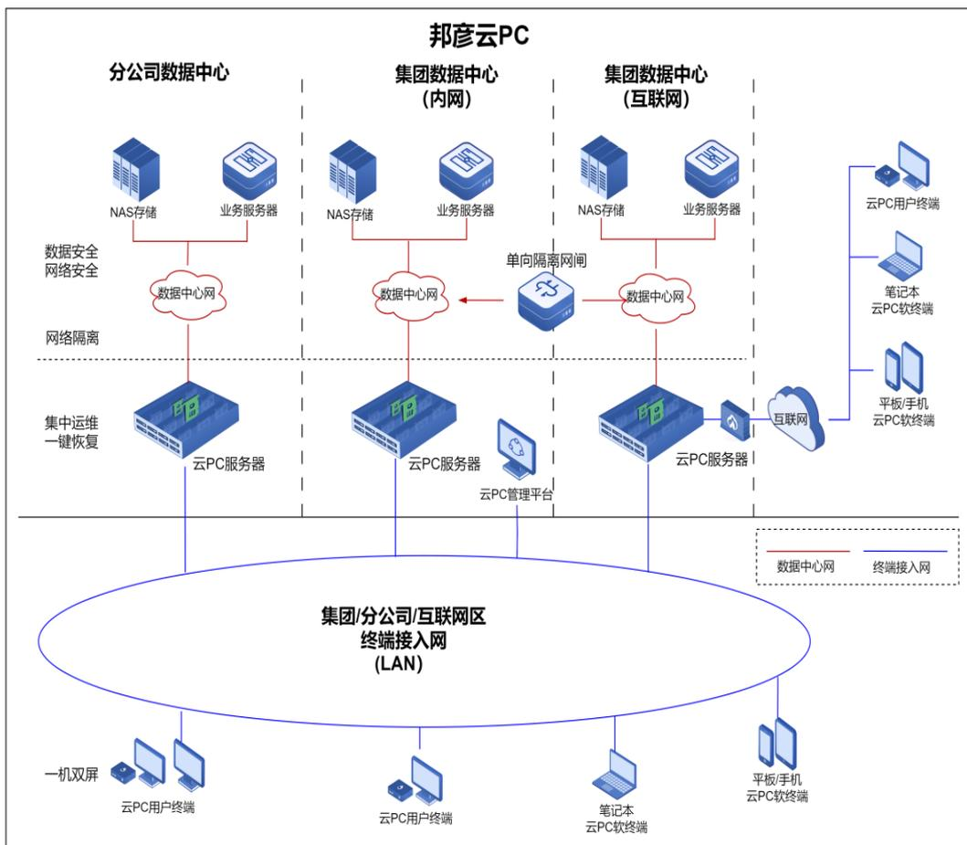
邦彦云 PC 系统是基于云计算技术的高性能且安全的计算解决方案。该系统通过在云端数据中心部署计算刀片阵列，为用户提供物理隔离的计算单元，以实现安全、灵活和高效的计算资源访问。
