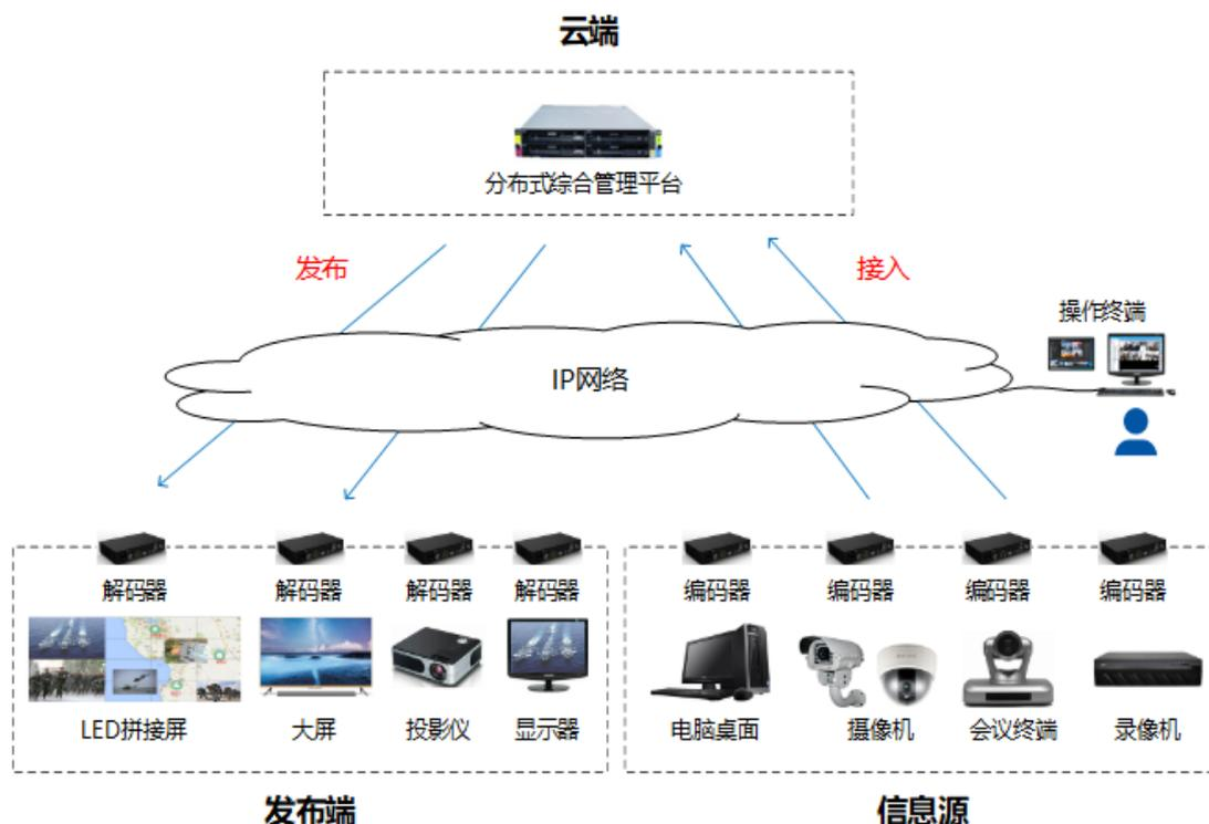
分布式音视频控制系统采用全 IP 化分布式控制和编码技术，实现了多源音视频信息分布式接入和发布的网络化控制，使得音视频传输更远，跨席位、跨房间、跨楼宇、跨区域之间发布、分享更便捷。分布式音视频控制系统采用软硬件结合的采集编码技术，实现视频低码、低时延的全彩效果，视频效果与无损压缩效果相近的同时，又极大降低了传输网络带宽和存储的要求；采用媒体流分布式处理技术，全网处理能力均匀分布，避免存在网络、性能瓶颈节点，且容量自由
