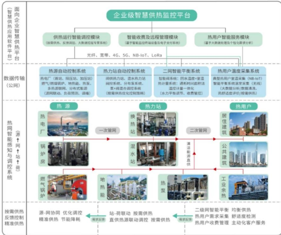
智慧供热平台构建了省、市、县、企业的供热信息化系统，形成“三级监管、四级联动、企业调控”的运行管理机制以保障城市供热安全、提高民生服务水平；通过基于室温监测的“荷、站、网、源”反馈调控策略，达到站荷联动、源网协同，从而实现按需供热、精准供热，提高了城市供热资源的配置效率，智慧供热已在北方采暖区成为智慧城市建设的垂直应用领域之一。
