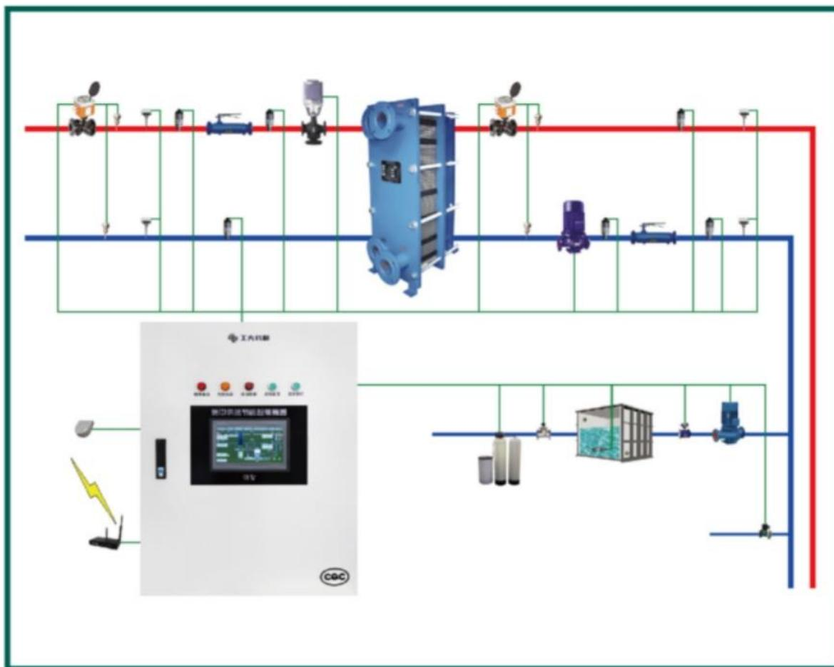
热力站自动控制系统由集中供热节能控制装置以及传感器、热量表、流量计、变频柜等仪表设备组成，具有稳态精度高、优化时间短、鲁棒性强、通用性高等特点，可实现气候补偿、室温反馈、故障远程监控、无人值守运行、自动节能运行等多种功能。
