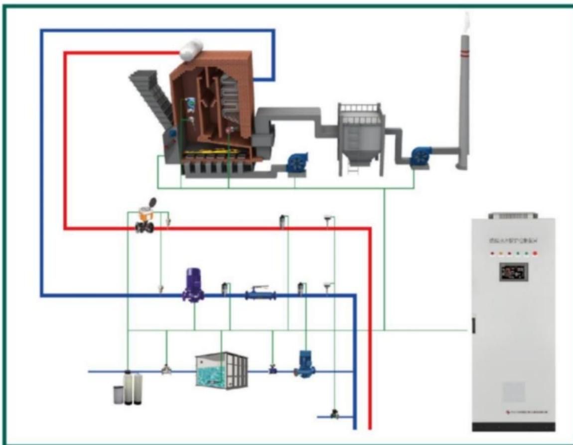
热源自动控制系统（热源包括燃煤锅炉、燃气锅炉、热电联产首站、大型隔压站等）由热源监控中心软件、热源节能控制装置以及配套的传感器、热量表、变频器等仪表设备组成。热源自动控制系统内置故障诊断与容错控制技术，具有热源故障诊断与安全控制模式及智能语音报警功能、热源运行及操作质量评价功能，该系统能够实现热源运行过程的准无人化，从而降低人力成本，提高热力企业的经济效益。
