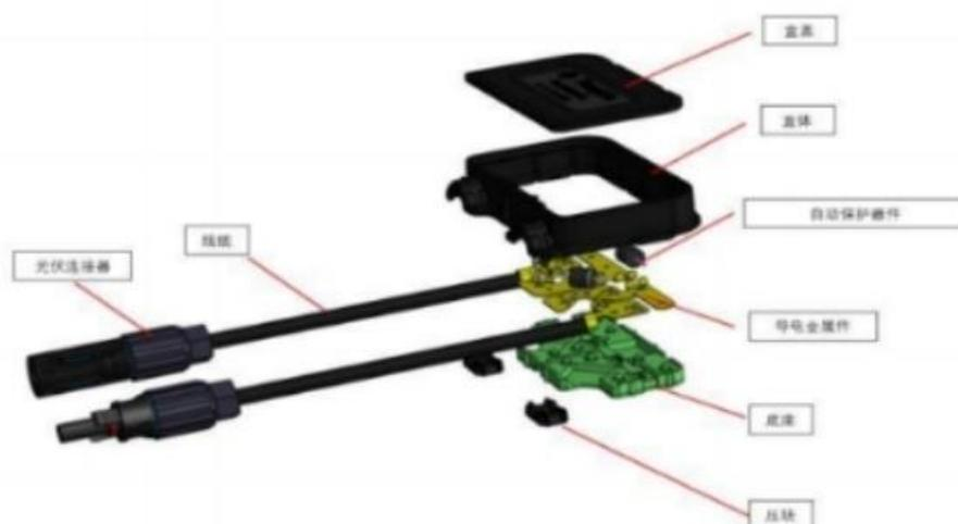
其中：①箱体、盒盖、底座等选用高分子材料通过注塑工艺生产制作而成，具备抗紫外线、耐热阻燃、抗老化等性能；②导体采用高散热性、高导电性的金属材料通过冲压工艺生产制作而成，具备良好的散热性能和优异的导电性能；③自动保护器件具备在光伏组件发生热斑效应时起到自动保护功能，所谓热斑效应指在太阳能组件的构造中，单个电池片被串联在一起，若其中一个电池片被遮挡，受影响的电池将不再作为电源工作，而是变为能量消耗者，其他未遮挡的电池板将继续通过它们传递电流造成较高的能量损耗，此时热斑效应就会出现，甚至可能产生电池损毁。为了解决这个问题，自动保护器件能自动工作起到保护作用，旁路电流绕过遮挡的电池片，经自动保护器件传递下去；④线缆、连接器作为光伏接线盒的通用配件，主要作用为连接光伏组件并传导其产生的电流。
