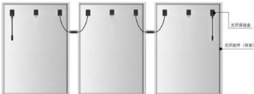
光伏接线盒产品主要由箱体、盒盖、自动保护器件、导体、底座、连接器、电缆线等配件构成。光伏接线盒结构图如下所示：
