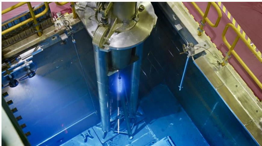
2024 年 4 月，碳-14 靶件从秦山核电重水堆机组中卸出后转移到临时储存水池中
