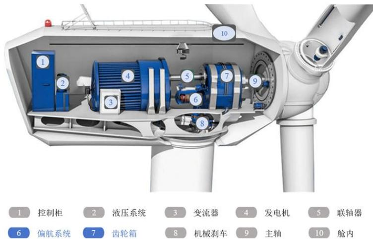
标的公司产品主要运用于风电机组的齿轮箱、偏航变桨系统等传动部件。齿轮箱和偏航变桨系统是将风能转化为电能的关键设备，风力发电机组通过偏航变桨系统调整叶片角度以最大化提高风能利用率，通过齿轮箱将风轮转动的低速运动转化为发电机所需的合适转速，从而驱动高效清洁发电。此外，齿轮箱和偏航变桨系统的性能和可靠性是风力发电机组能否正常运转的关键因素，关系到风力发电机组的发电效率和运行寿命。风电机组在运行时，传动部件需要承受强大载荷和恶劣的运行工况，海上风电机组还要面临强腐蚀的海洋环境，进而对齿轮锻件等核心零部件提出了更高的性能要求。
