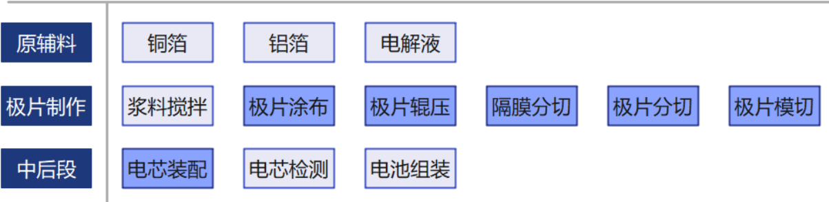
锂电池生产的主要工艺流程
