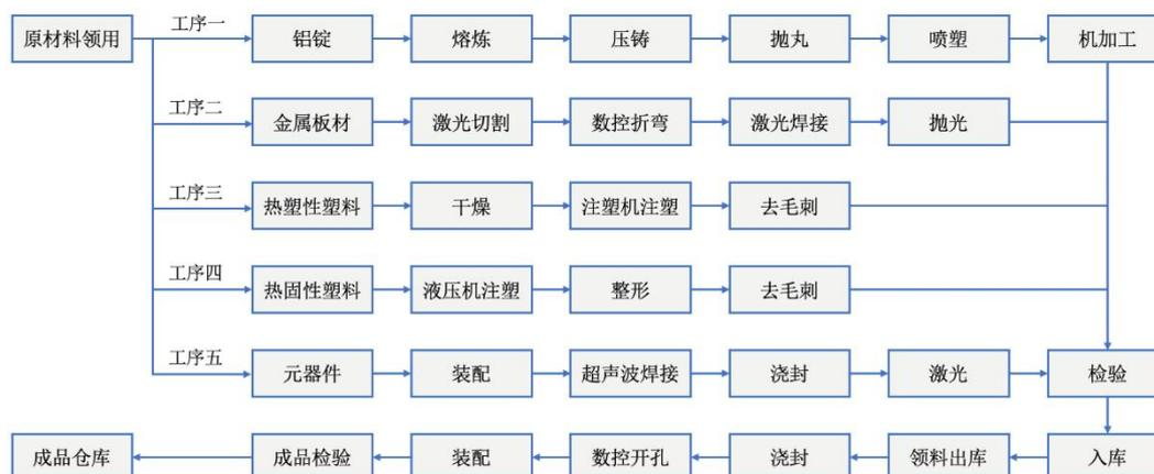
由上表，公司塑料产品主要涉及工序三、工序四，对应工艺主要涉及液压和注塑，金属产品主要涉及工序一、工序二，对应工艺主要涉及铸造、切割、
