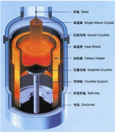
光伏单晶硅拉制炉
