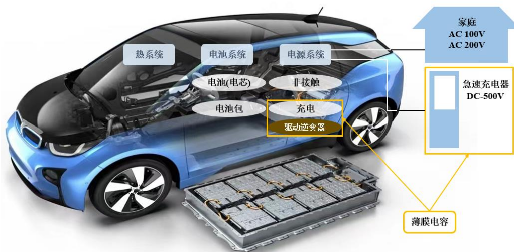
薄膜电容器在新能源汽车电驱上的应用图例
