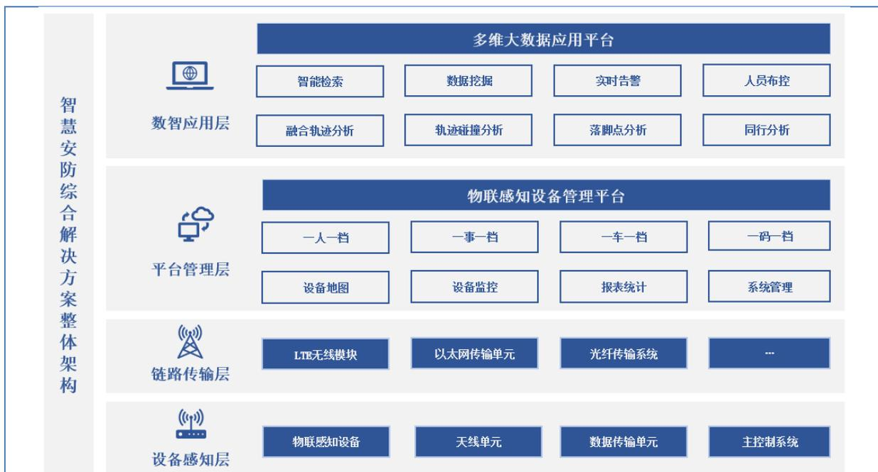
A、设备感知层：由具有感知、识别、控制等多种设备组成，通过感知各类环境数据信息，将物理世界和信息世界联系在一起，主要由物联感知设备（以移动网络可视化设备为核心）、天线单元、数据传输单元、主控制系统等构成。移动网络可视化设备自动感知经停感知设备覆盖范围内的无线信号，实时监测布控号码，通过数据链路与平台之间进行数据交换。
