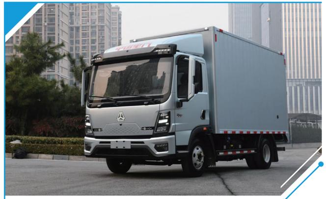
新能源市場，本集團新能源輕卡銷量同比增長186.1%，市場佔有率同比提升0.1個百分點。本集團不斷提升產品競爭力，全新發佈132kWh輕卡產品，匹配自主研發的5t電驅橋，創新性採用25.339/11.802兩檔速比，綜合能耗行業領先。
