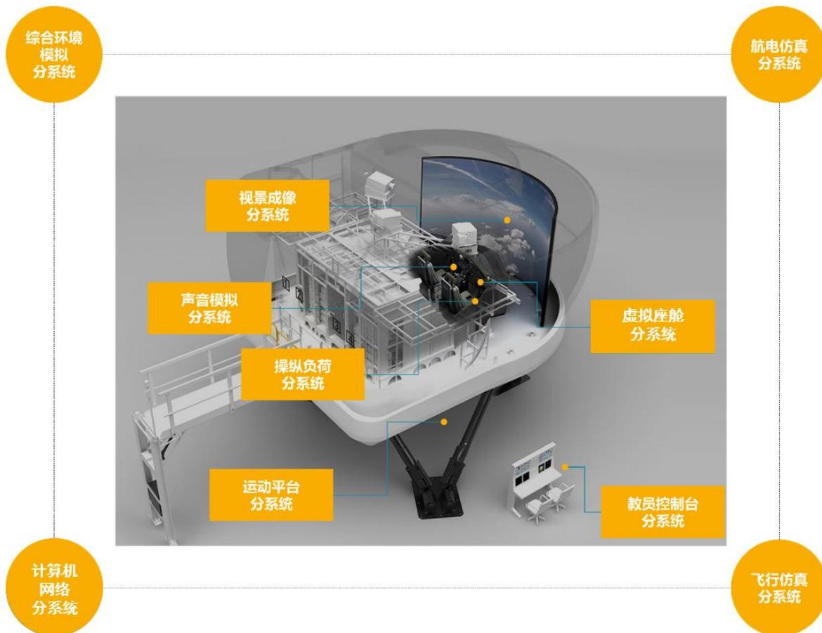
如上图所示，飞行模拟器中能够被受训者直观感受的分系统包括虚拟座舱分系统、视景成像分系统、声音模拟分系统、操纵负荷分系统、运动控制分系统、教员控制台分系统；而综合环境模拟分系统、航电仿真分系统、飞行仿真分系统以软件形式嵌入飞行模拟器。各分系统的功能与
