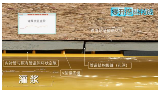
④原有管道缺陷
