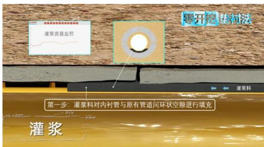
⑤管道内壁破损修复
