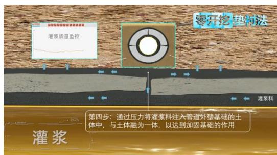
⑧对原有管道基础土体进行加固 (基础加固)
