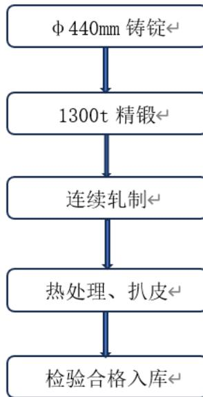
简洁的工艺流程可快速实现从海绵钛原料到线材成品交付，大大缩短产品生产的周期；通过短流程工艺减少了线材生产过程中多火次的墩拔等开坯变形和扒皮/修伤工序，使产品更易于过程质量控制、质量更有保障、批次质量稳定性更好。短流程工艺也能减少材料工序损耗，较少的生产工序使得产品材料利用率更高，使得生产成本更低，更具市场竞争力。
