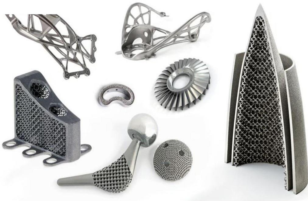
3D 打印钛部件：GE Additive 髋关节、Sciaky 风扇叶片、Arcam Darker 火箭尖端、3D Systems 钛晶格组件、EOS 钛支架、Zenith Tecnica 外科脊柱植入物
