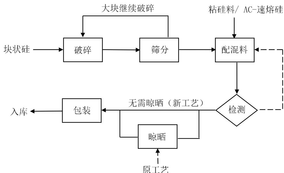
D、铝基中间合金生产工艺流程图
