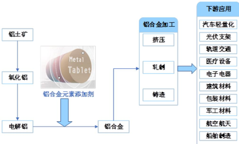
如图，在铝合金产业链中，铝合金金属添加剂用于原铝熔炼合金化过程，根据工业需求向铝熔体中添加锰、铁、铜、钛、铬等元素，调整铝合金组份构成、改善金相组织、提高合金纯洁度，会直接影响铝合金产品的质量和性能。
