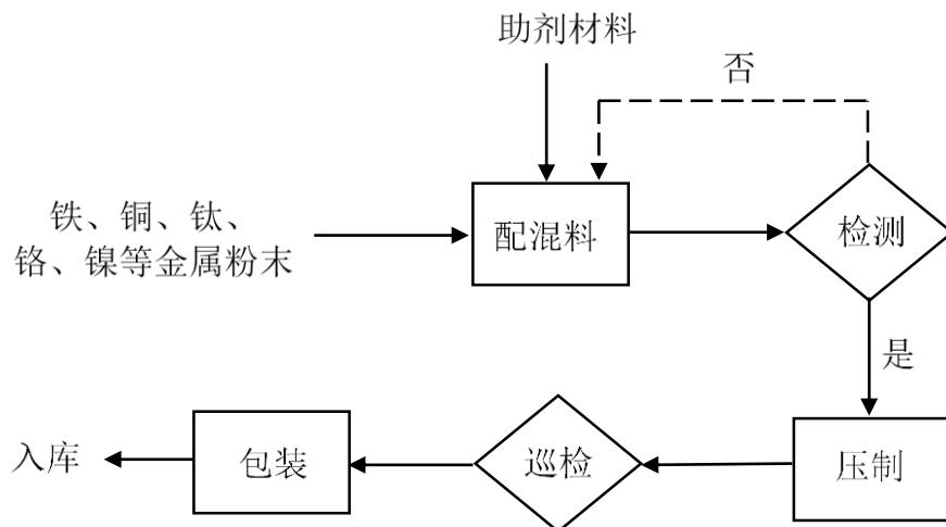
C、速熔硅生产工艺流程图
