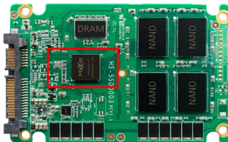
PCIe 接口固态硬盘内部构造图
