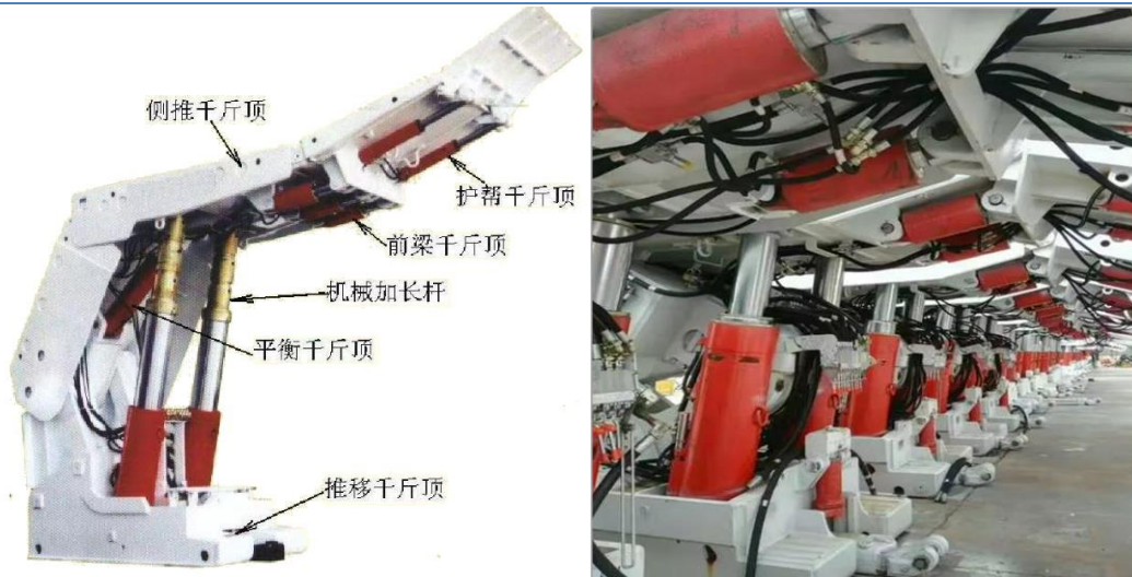
液压支架千斤顶与液压软管分布
