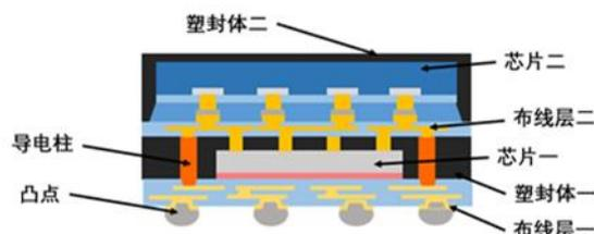
HCoS-OT 产品核心工艺同 HCoS-OR 产品基本相同，两者区别主要在于：HCoS-OT 产品封装体内结构为上下两层晶粒堆叠，两层晶粒通过高铜柱进行互联。因此在生产过程中，需要先对第一层晶粒及其玻璃载具实施晶圆重布线、晶圆重构工艺，制作第一层晶粒的重构晶圆并将电气通路引出；然后将第二层晶粒堆叠在第一层重构晶圆上，进行第二轮晶圆重构，将上下两枚晶粒都用塑封材料保护起来；最后将第一层晶粒的玻璃载具解键合，在重布线层实施晶圆重布线和晶圆凸点工艺，使其具备连接基板的电气通路。
