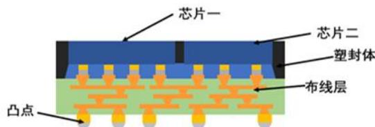
HCoS-OR 与 RWLP 产品在工艺方面的主要区别为工序步骤和核心工艺的实施次数：RWLP 产品是在金属载具上先进行重构晶圆工序，然后在重构好的晶圆上实施单层晶圆重布线，最后再进行晶圆凸点工艺。HCoS-OR 产品是先将来料晶圆进行第一次晶圆凸点工艺，再切割成晶粒备用；然后在玻璃载具上实施多次晶圆重布线工艺，使其形成多层布线；再将做好晶圆凸点的晶粒贴装到重布线好的载具上，进行晶圆重构工序；最后在重构好的晶圆上进行第二次晶圆凸点工艺。
